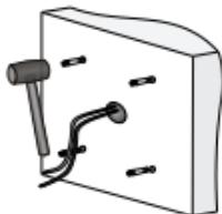
敲击膨胀螺栓，确认其固定在孔内无松动
