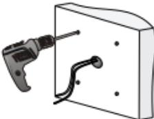
选择钻头与膨胀螺栓外径匹配，孔深参考螺栓的长度
